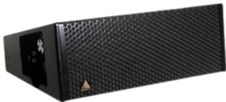
Conçu pour une facilité d'utilisation optimale, le Adamson SpekTrix est un haut-parleur actif à trois voies qui utilise deux haut-parleurs dédiés en Kevlar Neodymium de 8 pouces et un haut-parleur de compression haute fréquence de sortie de 1,4" monté sur une chambre sonore à mise en forme d'onde exclusive.
